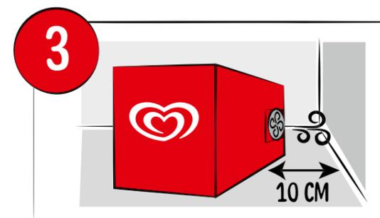
3 Genügend Freiraum für Luftzirkulation hinter dem Kompressor lassen.
