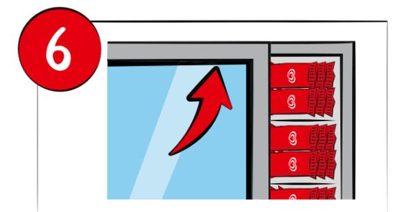
6 Dichtungen überprüfen, damit keine warme Luft in das Gehäuse eindringt.
